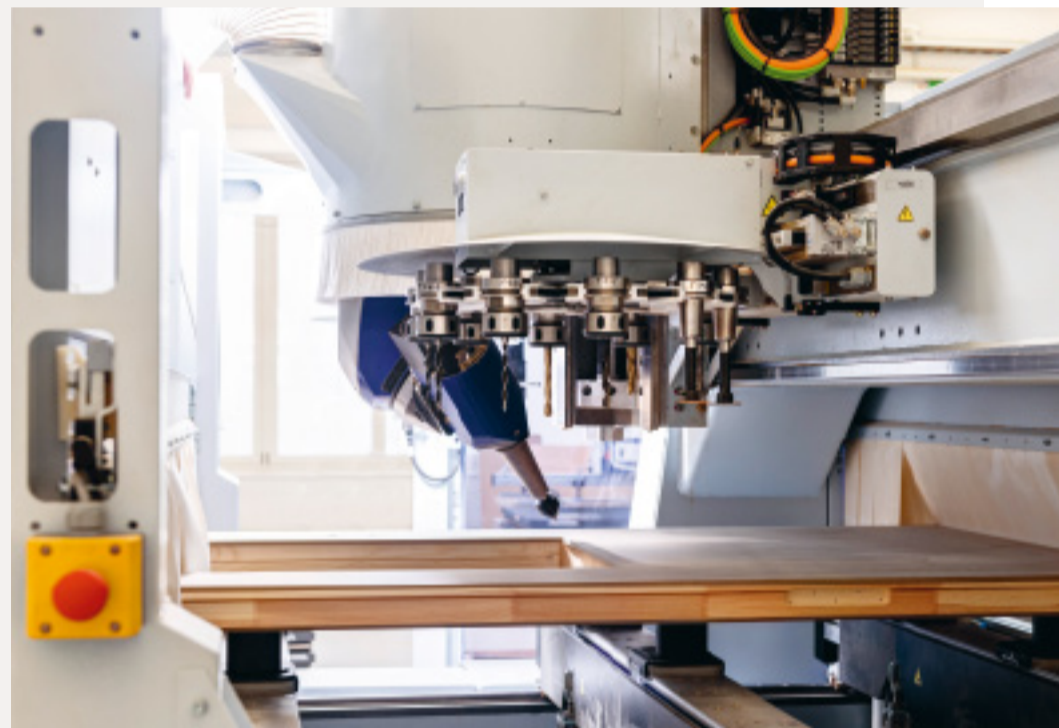
Die 5-Achs-Technologie ermöglicht auch komplexe Fräsungen.
