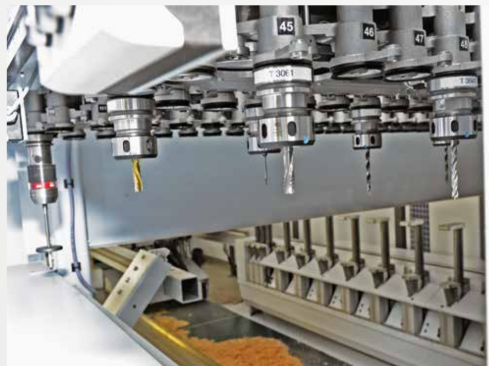
Der Werkzeugwechsler ist mit verschiedensten Werkzeugen für die einzelnen Bearbeitungsschritte ausgestattet. Dadurch ist eine umfangreiche Bearbeitung in kurzer Zeit möglich.
