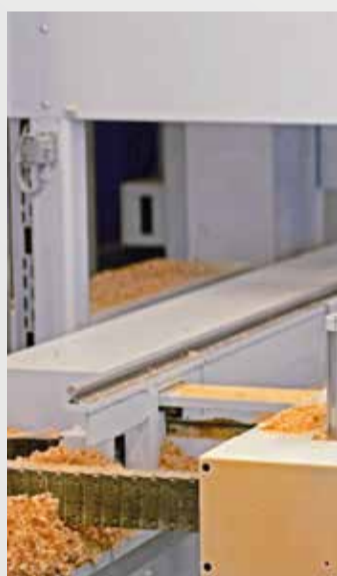
Zur beidseitigen Bearbeitung wechselt die Maschine selbstständig den Bearbeitungsplatz.
