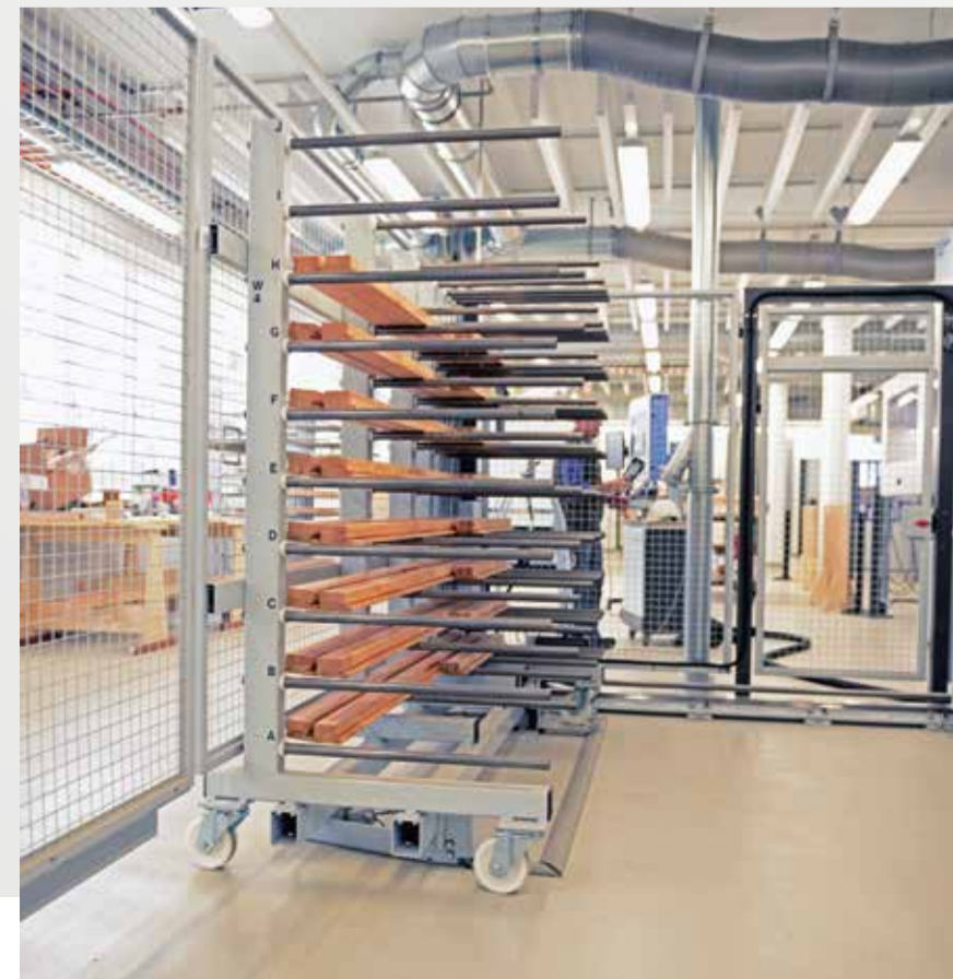
Die Rohlinge sind bereits millimetergenau zugeschnitten und den entsprechenden Etagen im Wagen zugeordnet. Die Maschine entnimmt dem Wagen nun selbständig die für den konkreten Auftrag benötigten Rohlinge und bearbeitet sie.
